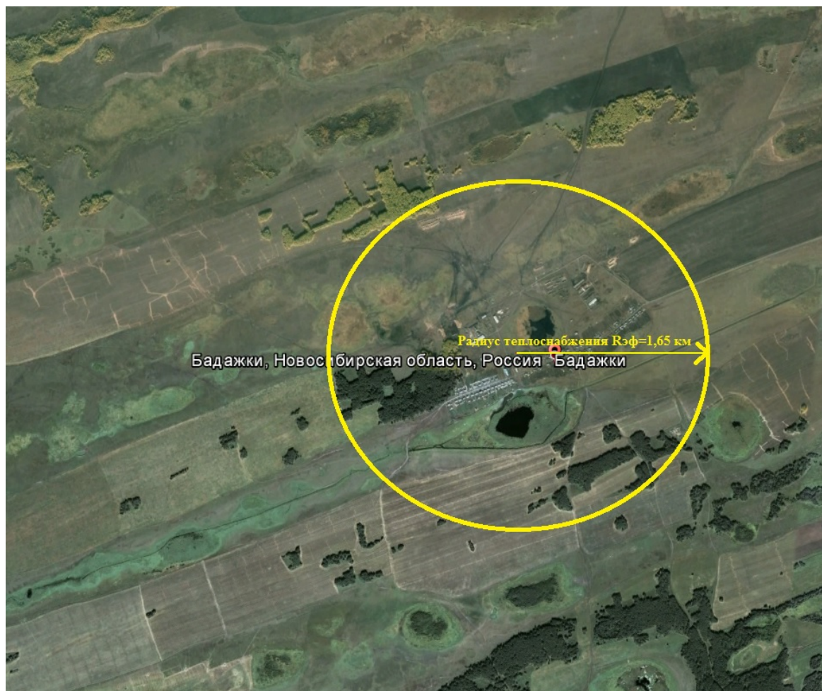
Рисунок 2.1 – Радиус эффективного теплоснабжения котельной д. Бадажки
